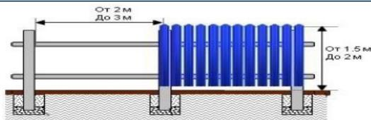
Металлический штакетник — один из наиболее популярных строительных материалов для ограждений. Материалом для производства служит оцинкованная сталь с полимерным покрытием или без него.
